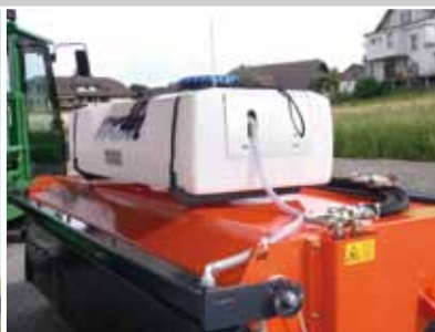
urządzenie zraszające ze zbiornikiem wody 100/200 l
