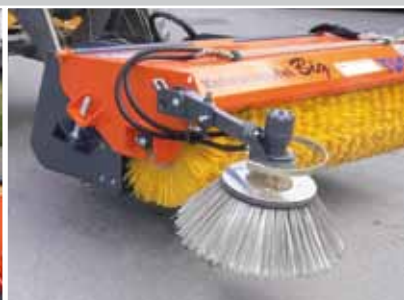
szczotka boczna z elementem sprężynowym (50 % PP / 50 % stal)
