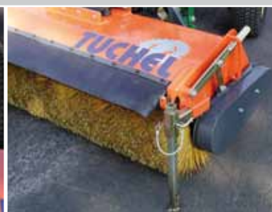
System dźwigni blokującej i stopa podporowa
