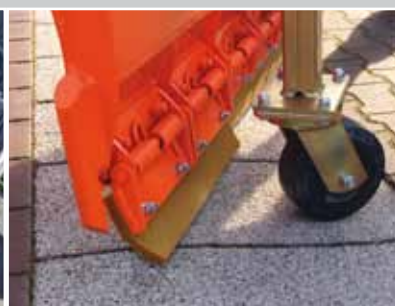
Kłapy sprężynowe bezoblodzeniowe; standardowa wyposażona z muldą ograniczającą z
