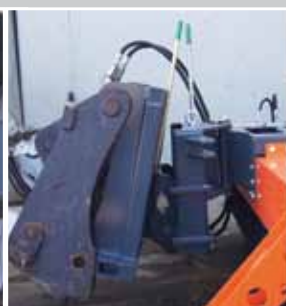
Wałek rolkowy ze wskaźnikiem wysokości i wyrównaniem wahań
