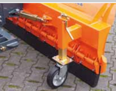
Bezstopniowa regulacja wysokości kół podporowych
