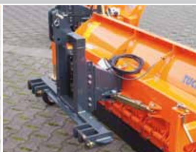
Zamocowanie poprzez trójpunktowy układ zawieszenia
